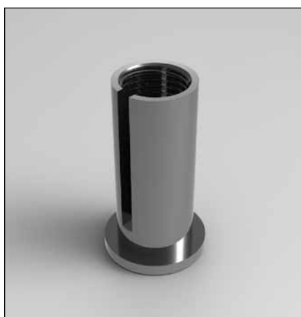
Ms Deckenhalter zylindrisch mit seitlichem Schlitz 3,2 mm Befestigungs- bohrung 5,0
